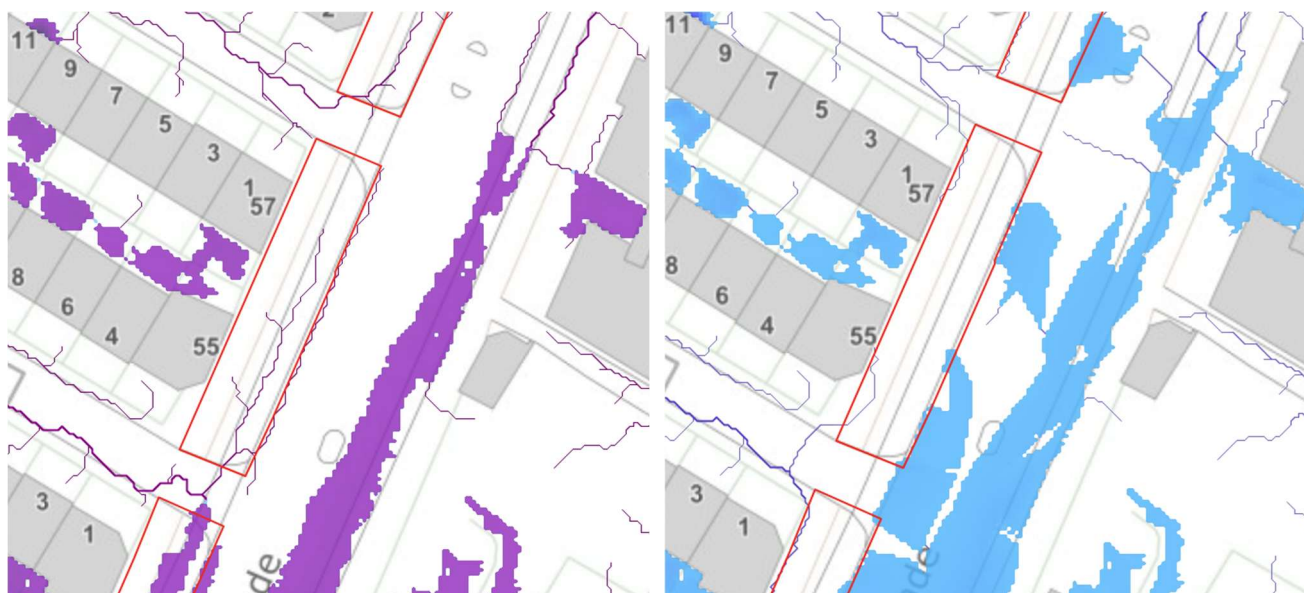
Figur 7.12 Oversvømmelseskort for strækning F med strømningsveje og bluespots ved en fremtidig 100 års-hændelse for status (til venstre, markeret med lilla) og for plan (til højre, markeret med blå). Delstrækningerne er markeret med rødt. Kilde: Scalgo Live.
