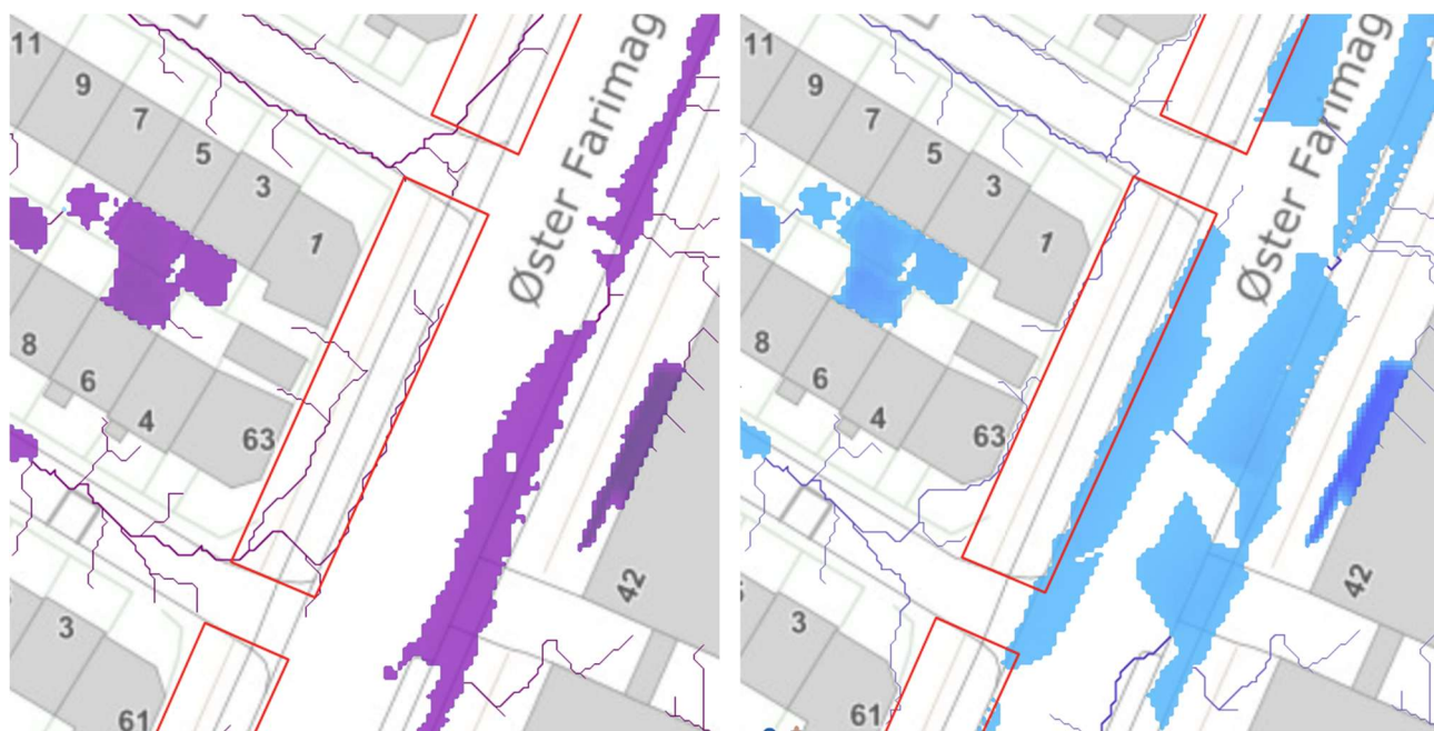
Figur 7.16 Oversvømmelseskort for strækning H med strømningsveje og bluespots ved en fremtidig 100 års-hændelse for status (til venstre, markeret med lilla) og for plan (til højre, markeret med blå). Delstrækningerne er markeret med rødt. Kilde: Scalgo Live.
